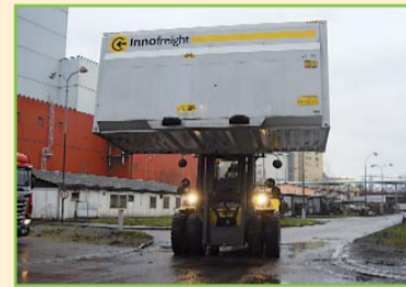
Po vycouvání od kolejí se zvednutím kontejneru uvolní výhled pro řidiče
