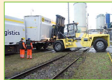
Po zasunutí vidlic je třeba kontejner mírně nadzvednout a naklopit
