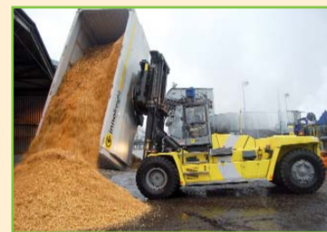
Kontejner se začíná naklápět, štěpka padá na skládku
