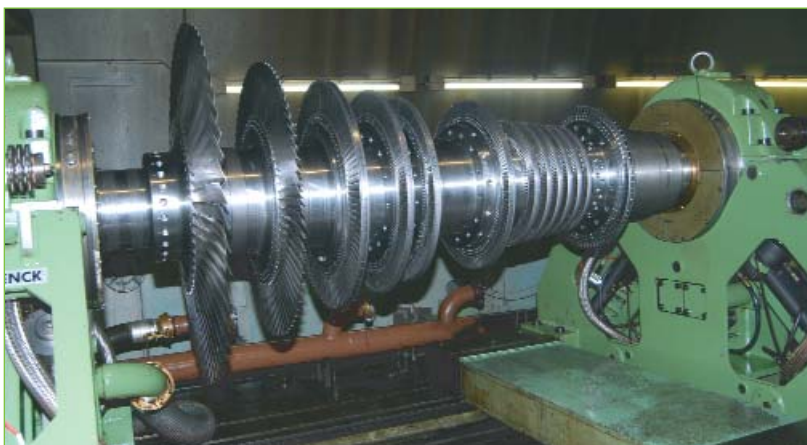
▲ Rotor naší nové turbíny na vyvažovačce ve zkušební Škody Power. Bude se otáčet 8100 krát za minutu.
